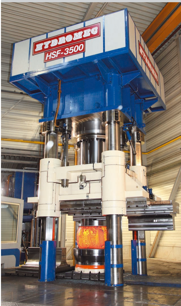
Náš vysokovýkonný lis s tlakom 35 MN tvaruje obrobky až do hmotnosti štyroch ton
